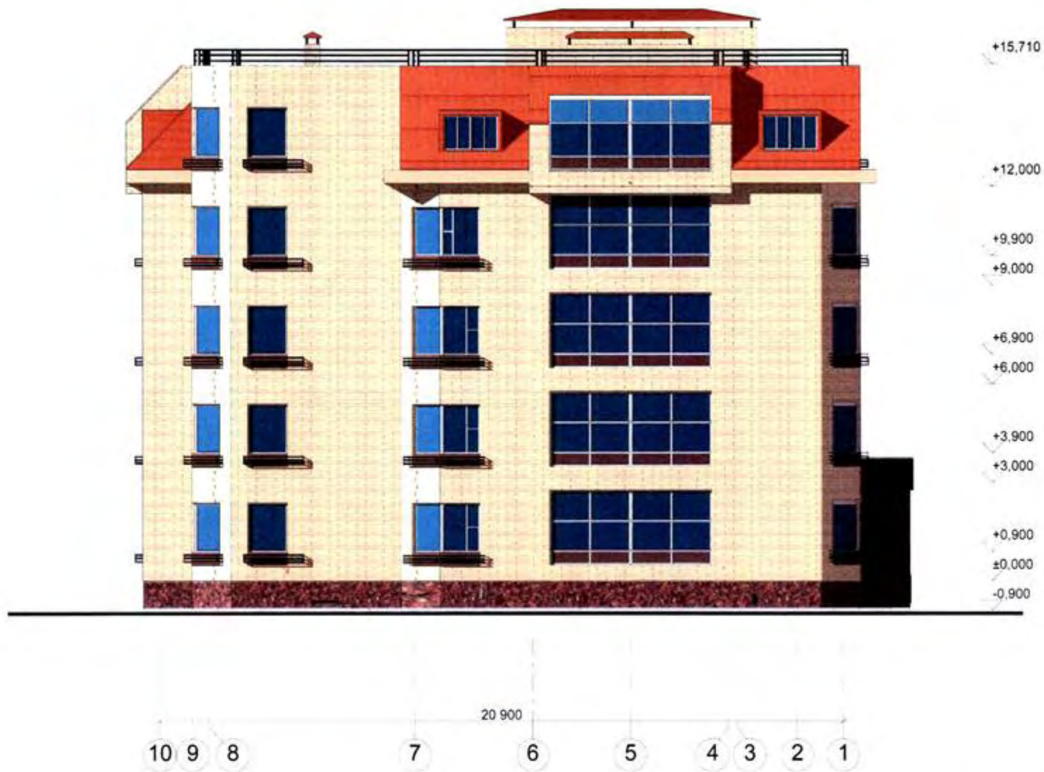
Фасад жилого дома меридионального типа в осях 10-1 Микрорайон "Северный", г. Руза, МО
