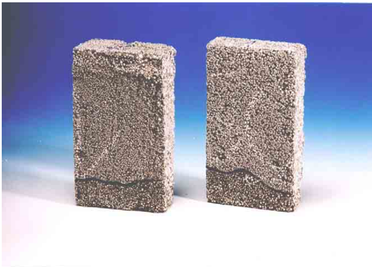
Рис.2. Высота увлажнения образца по завершении процесса капиллярного подъема.
