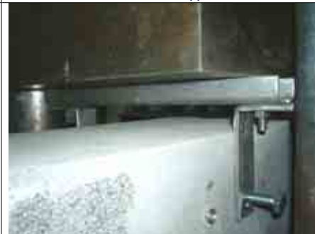
ИСПЫТАНИЕ НА СДВИГ КРЕПЕЖ МЕТАЛЛИЧЕСКИМИ ДЮБЕЛЯМИ
