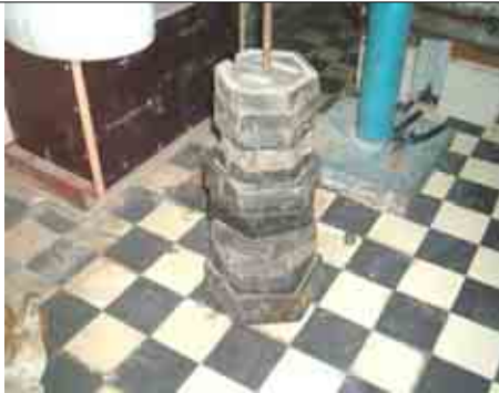
ИСПЫТАНИЕ НА ВЫТЯГИВАНИЕ КРЕПЕЖ САМОРЕЖУЩИМИ ПЛАСТИКОВЫМИ ДЮБЕЛЯМИ
