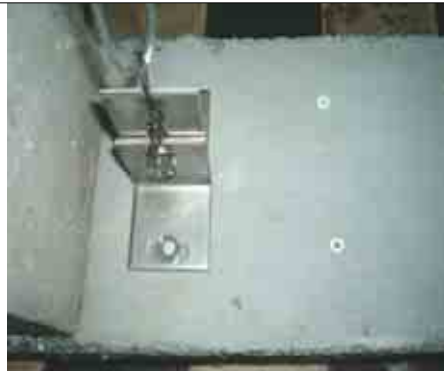
ИСПЫТАНИЕ НА ВЫТЯГИВАНИЕ КРЕПЕЖ КЛАССИЧЕСКИМИ ПЛАСТИКОВЫМИ ДЮБЕЛЯМИ
