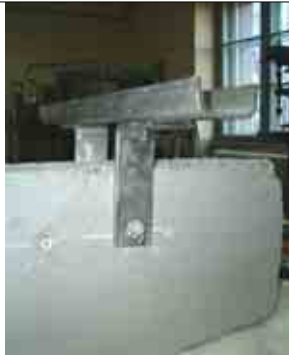
ИСПЫТАНИЕ НА СДВИГ КРЕПЕЖ САМОРЕЖУЩИМИ ПЛАСТИКОВЫМИ ДЮБЕЛЯМИ
