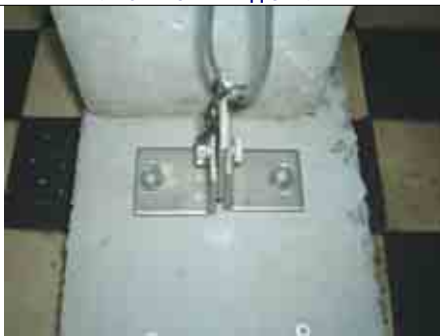
ИСПЫТАНИЕ НА ВЫТЯГИВАНИЕ КРЕПЕЖ САМОРЕЖУЩИМИ ПЛАСТИКОВЫМИ ДЮБЕЛЯМИ
